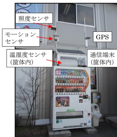
図4 自販機上設置のセンサ端末の例
