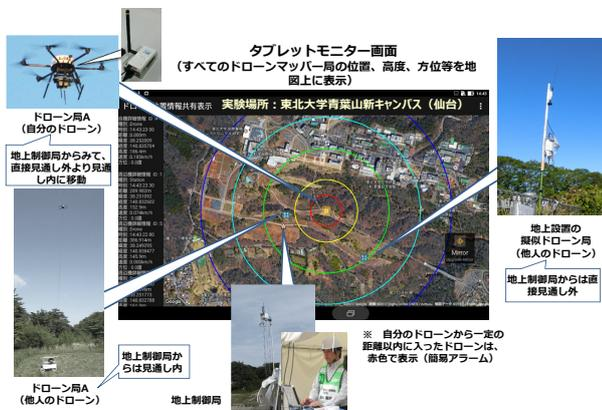
図 14 ドローンマッパーの無人機への搭載とタブレット画面
