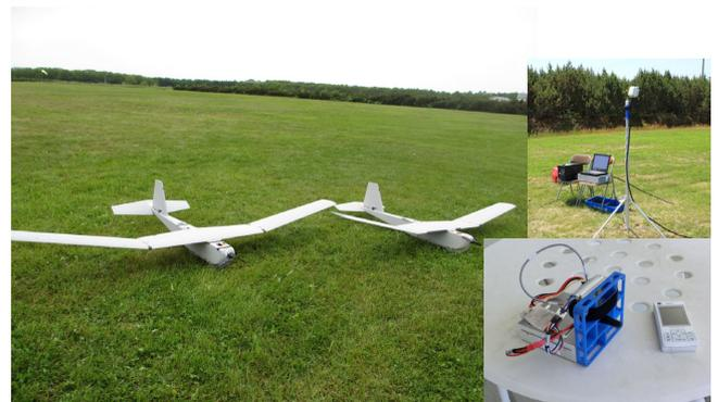
図1 導入した小型無人機 Puma-AE と開発した無人機搭載用無線中継ユニットと地上局
