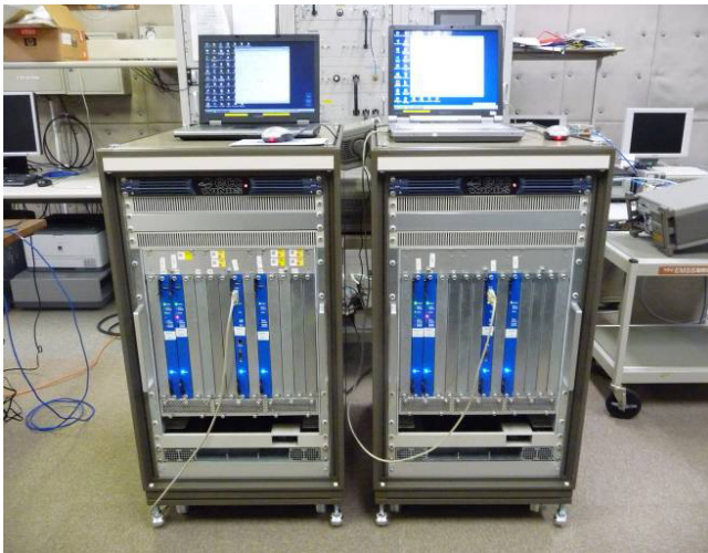
図7 622/1244 Mbit/s 高速バーストモデムの外観
