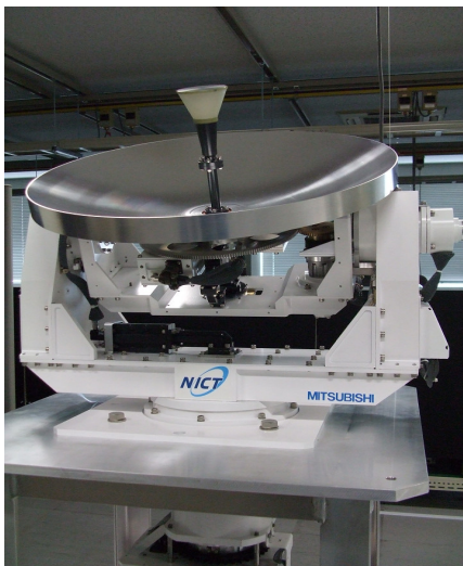
図2 航空機地球局アンテナ外観
