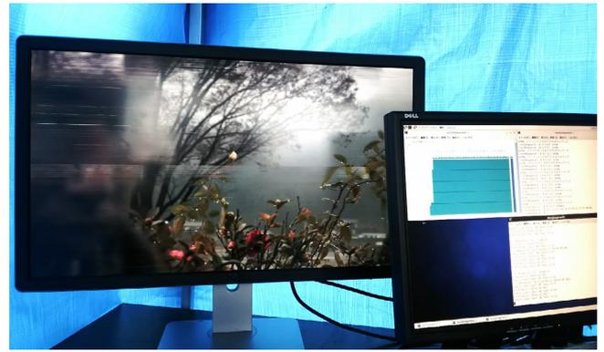
図7 WINDS衛星による4K映像伝送試験(画面上にノイズが確認できる)
