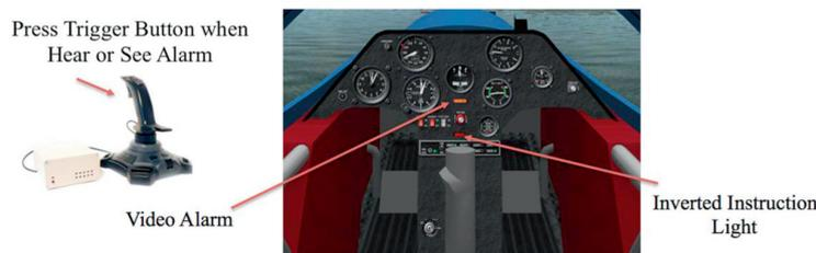
(a) 航空機の操縦を模擬した実験システム
