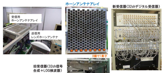
図 5 電子走査雲観測レーダー (ES-SPIDER) 左：送受信システム、中上：ホーンアンテナアレイ、 中下：旧受信器、右：新受信器
