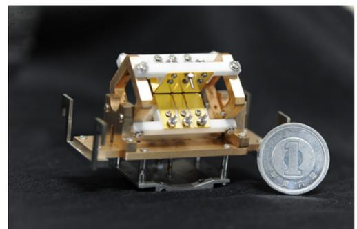
図2 linear-Paulトラップ電極概略図(side view, front view)及び実際に作製した電極の写真
