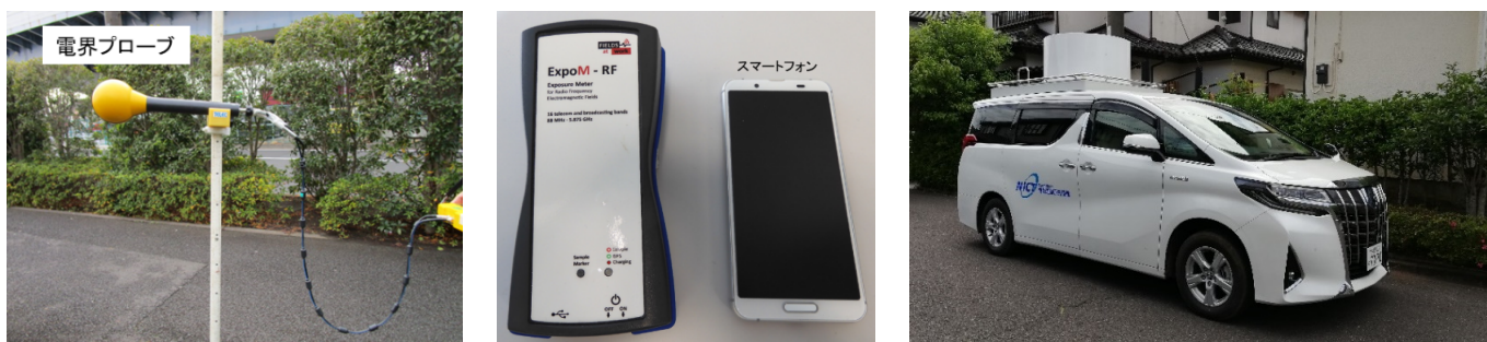
図8 電波ばく露レベルモニタリング手法の概要(電磁界プローブによる定点測定(左図)、携帯型測定器による測定(中図)、電測車による測定(右図))
