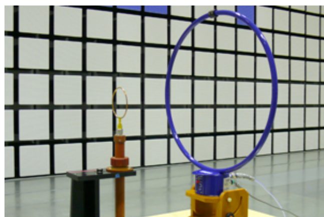
図5 標準電界法によるループアンテナの校正
