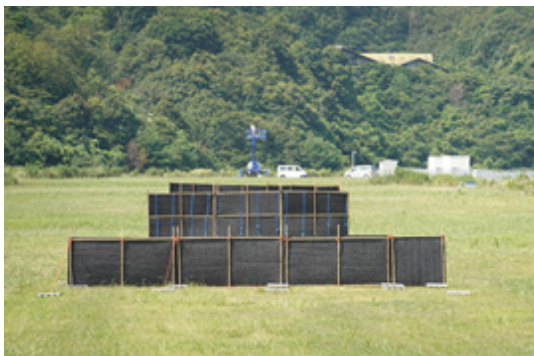
図8 多重反射防止板の配置実験風景
