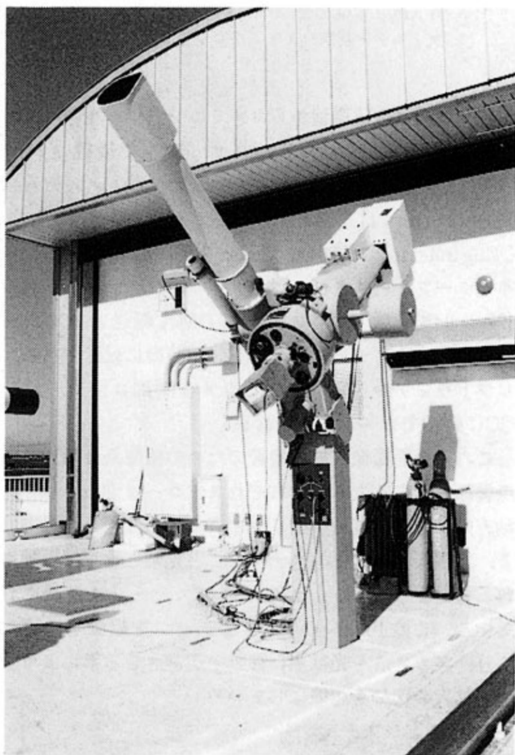
第1図 望遠鏡の全景を示す。スライディングルーフ式観測室が後退し、露天観測場となる。
