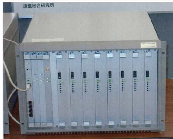
図4 マルチチャネル方式衛星双方向時刻比較装置の外観。送信2チャネル、受信8チャネルを装備。
