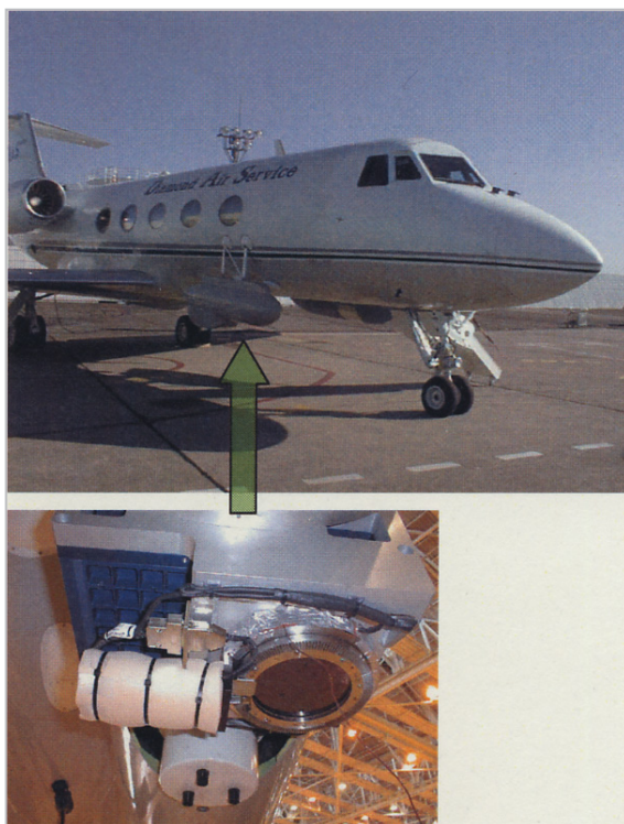
図2 航空機搭載ドップラーライダー
