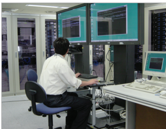
図3 不正アクセス再現実験装置 (SIOS)
