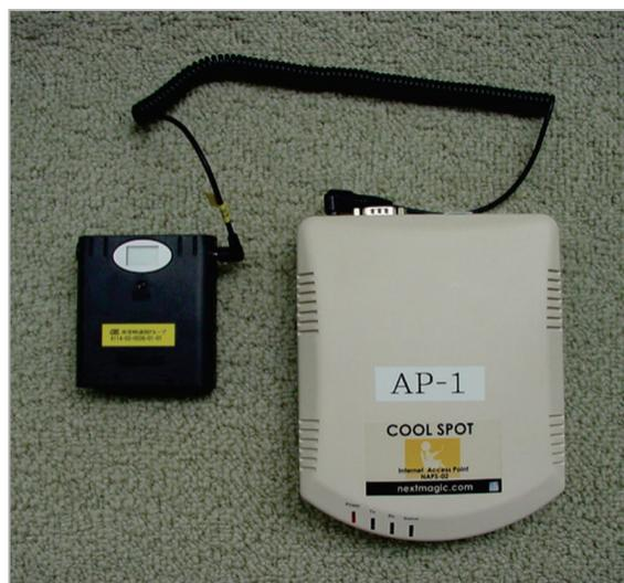
図16 実験に使用した無線 LAN アクセスポイント(外付けの充電式電池により稼動)
