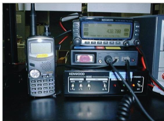
図9 アマチュア無線機を用いたDTMF符号による簡易データ通信実験セット一式(左)被災地移動局用ハンディ無線機(DTMF符号送出用テンキー内蔵)、(右上)被災地外基地局用無線機、(右下)フォーンパッチ用テレホンインタフェース装置
