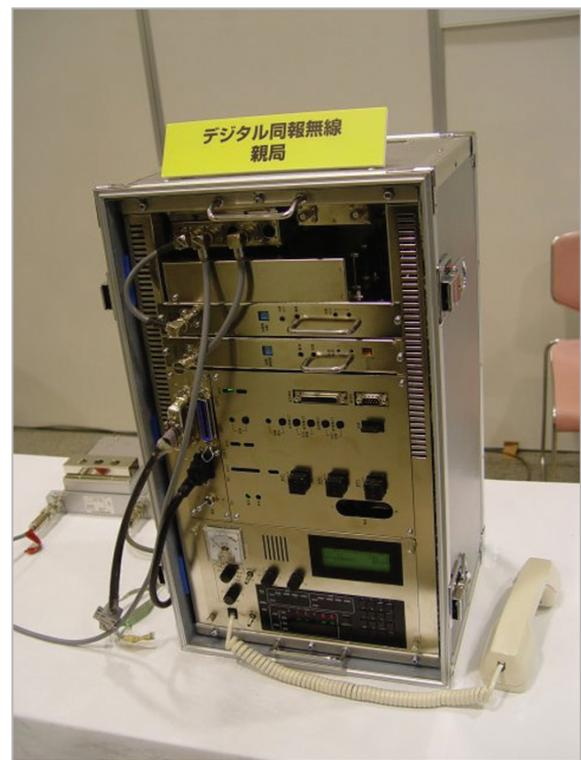
図3b 防災無線親局装置（沖電気製）
