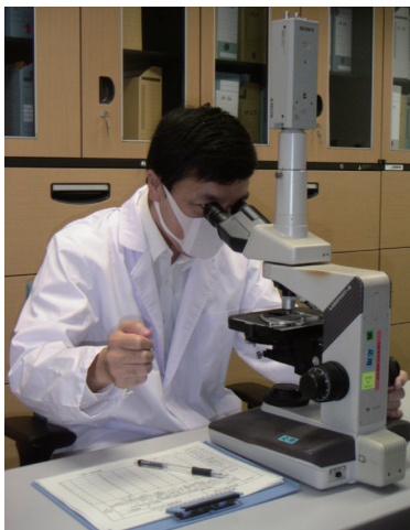
図1 従来法によるアスベスト測定 (右手にカウンターを所持)
