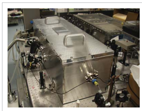
図3 広帯域 THz-TDS 測定装置の外観
