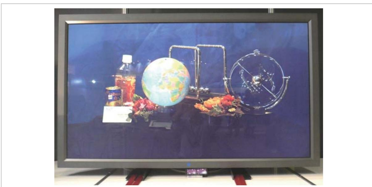
図 18 4K3D 液晶ディスプレイシステム
