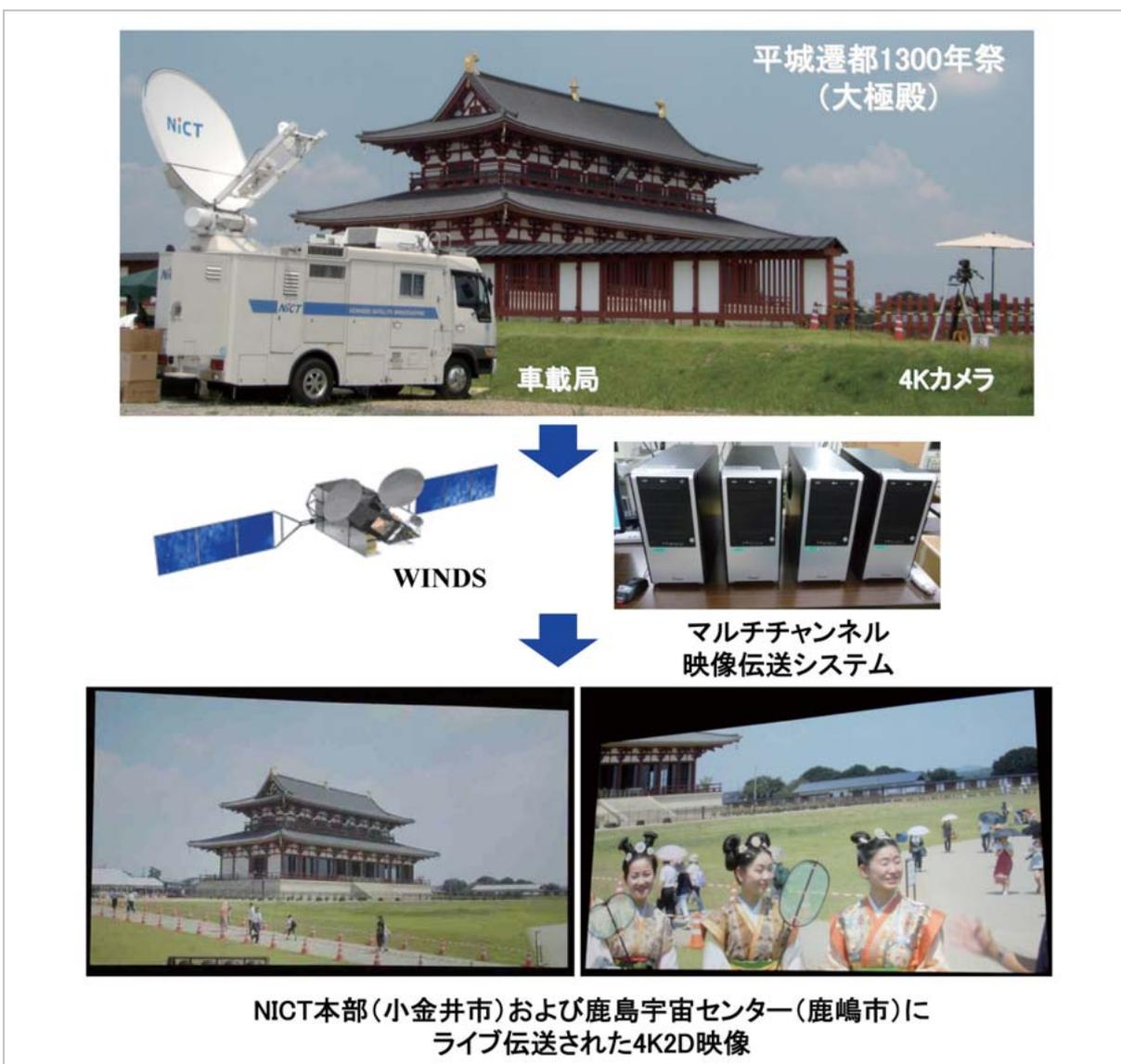
図 21 WINDS を用いた 4K 映像伝送実験
