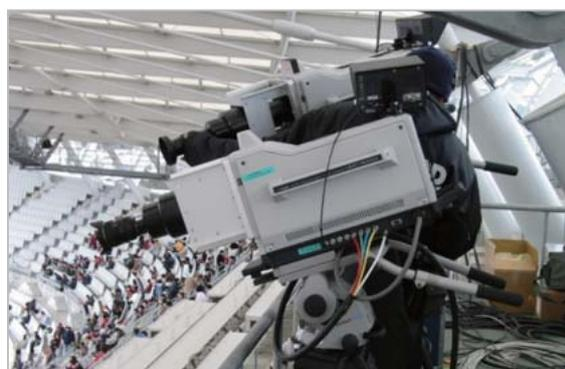
図 13 カシマスタジアムに設置された 2 台の 4K2K カメラ
