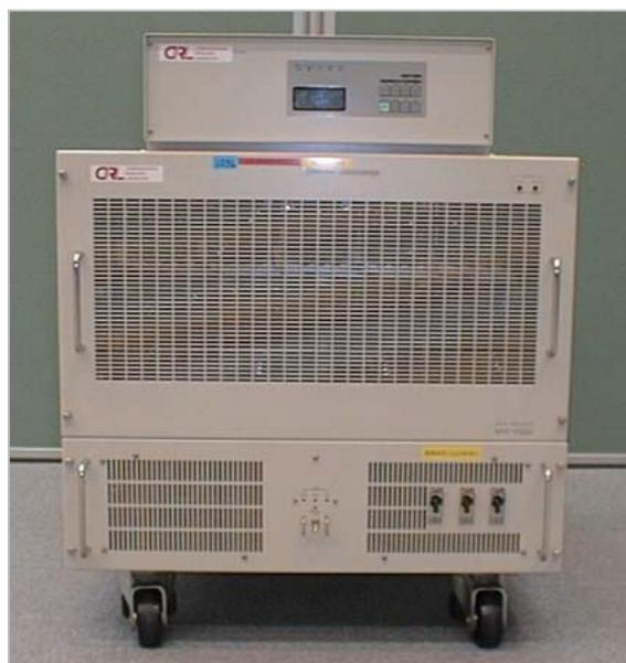
図8 低遅延MPEG映像伝送装置
