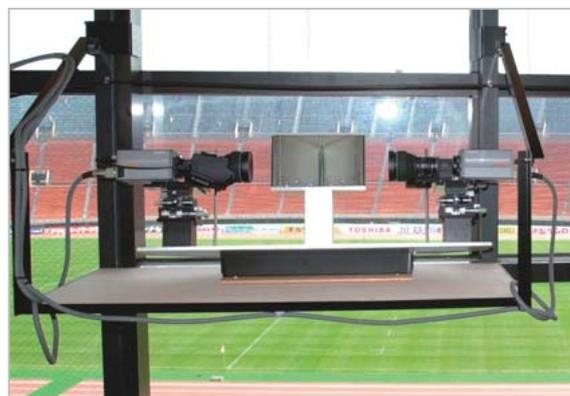
図9 国立競技場に設置された4K1Kカメラ
