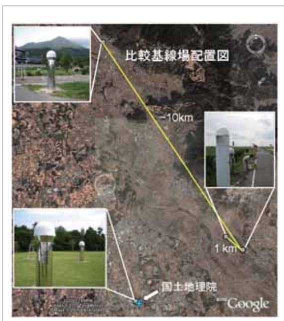
図 1 つくば市に設置された GPS 比較基線場
