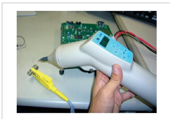
図9 サージ照射実験
