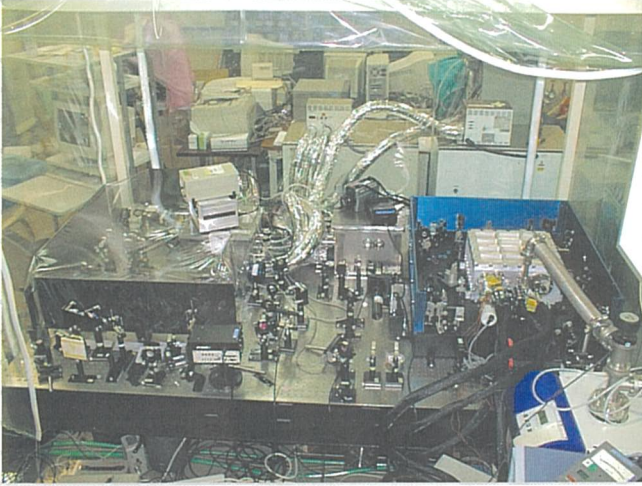
光学ベンチ上に組み上げられたサブスケールレーザ装置
