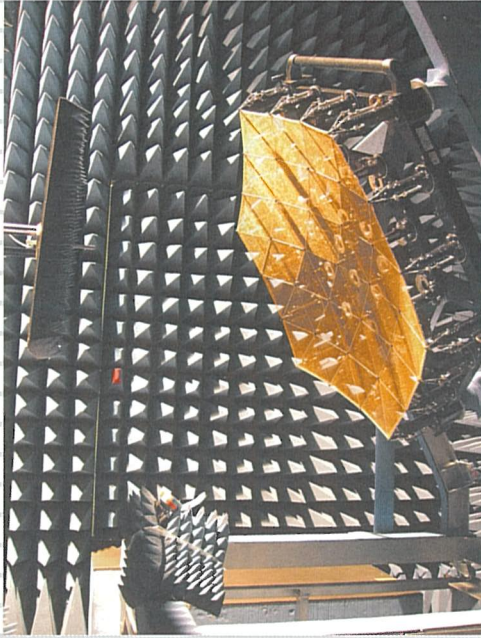
準天頂衛星用展開アンテナ 電気性能試験
