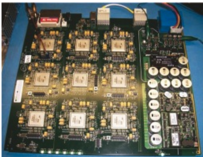
ターボプロダクト符号(TPC)復号部 622Mbps復調時、Eb/No=5.8dBで誤り率 1 \times 10^{-10} 以下 (昨年度開発の622MbpsQPSKバースト復調部に接続)
