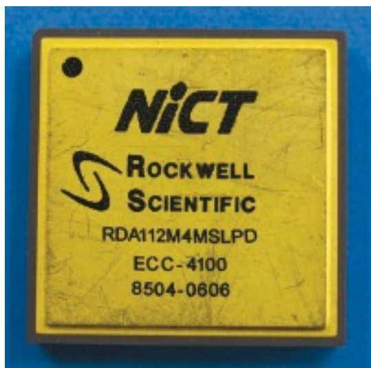
試作評価を行った高速D/A変換LSI (12bit、2Gサンプル/秒、SiGeプロセスにて開発)
