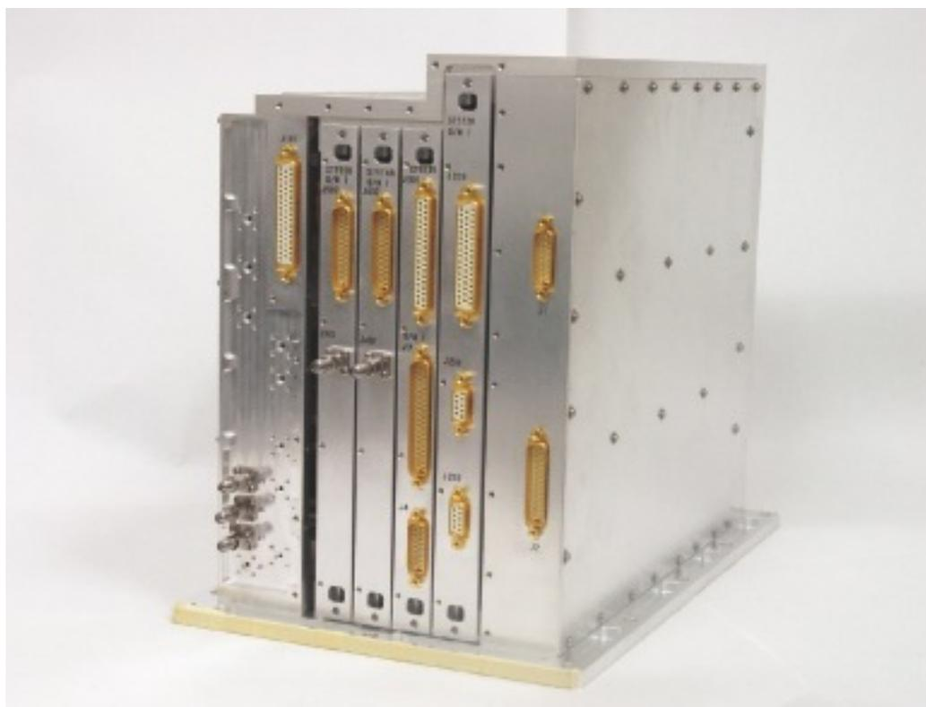
時刻管理系搭載部のEM(工学モデル)の外観
