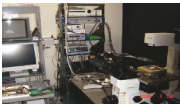
開発した単一分子計測システム
