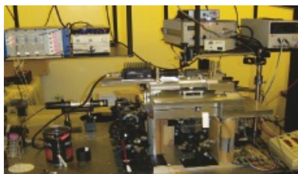
開発した微小力測定装置
