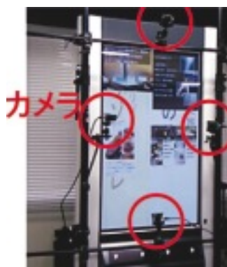
複数カメラとディスプレイを用いた非言語情報取得装置
