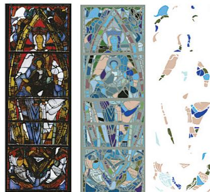
図3 複数の白色顔料を用いたステンドグラス風の作品(左)のテラヘルツ波分光結果(中、右)
