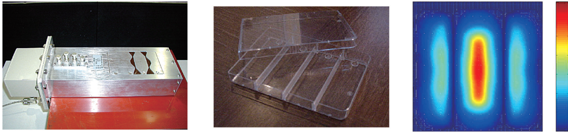
図3 細胞ばく露装置(左:スリット導波管、中央:専用の細胞培養容器、右:培養容器内電界強度分布(中心部に高強度領域))
