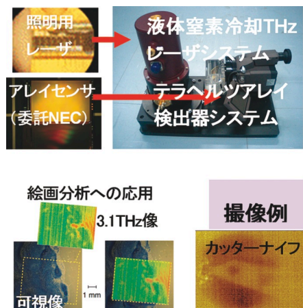
図5 イメージングシステムの写真とこのシステムによるテラヘルツ帯イメージの撮像例
