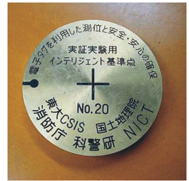
図1 公開実証実験のために流山おおたかの森駅周辺の歩道に設置したRFID内蔵測位基準点
