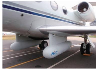
図2 航空機に搭載されたレーダのアンテナ部
