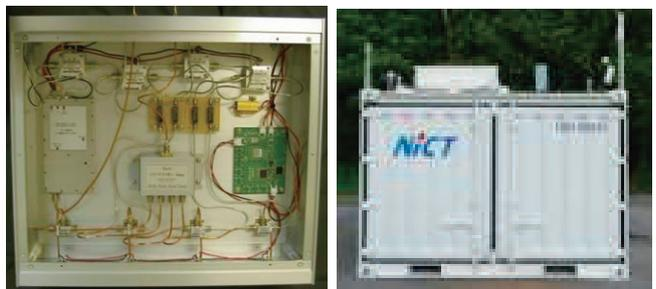
図 5 (左) GPM/DPR 外部校正用レーダ校正器 Ku 帯 RF 受信部。(右) 可搬型地上降水観測装置。
