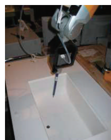
図4 SAR測定用カーブ付き平板ファントムの構造と概観（写真）
