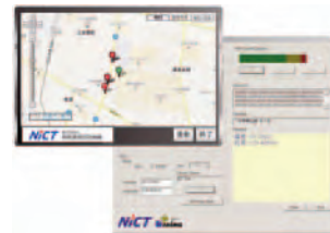
図7 サイレン音への緯度経度情報重畳による緊急車両の位置把握技術
