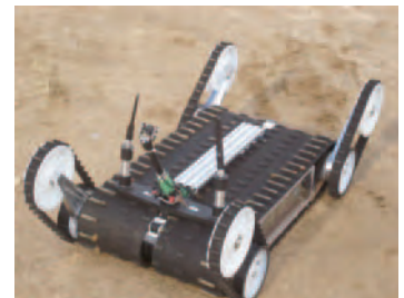
図1 開発した防水・防塵アンテナ台を取り付けた閉鎖空間内高速走行探査群ロボット実用機「クインス」
