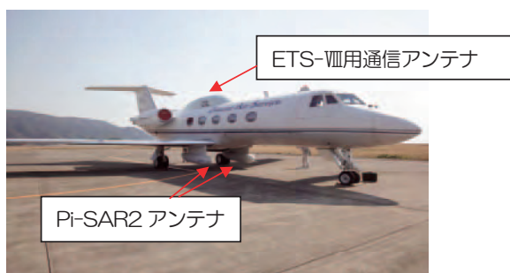
図 2 Pi-SAR2 と ETS-VIII 用のアンテナを装備した航空機
