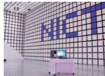
図5 V/UHF帯大型5/6面共用電波暗室
