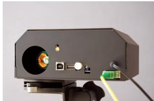
光ファイバによる高速回線が各家庭に普及してきている。光ファイバも電力線のように末端まで線を敷設しなければならないが、この装置は、その一部分を電波のように空間を通じて伝えることができる。しかも、光ファイバの持つ高速性能はそのまま維持できるため、TV 報道等の臨時的回線を簡単に敷設できる効果がある。
