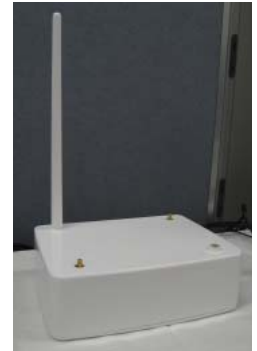
図3 開発したホワイトスペース無線機（左：基地局、右：移動局）
