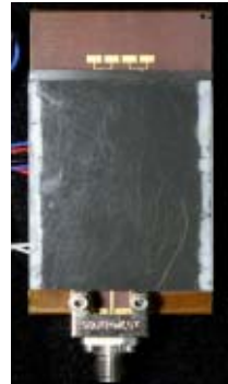
図2 左：開発したミリ波無線信号処理部、右：開発したビームステアリングアンテナ
