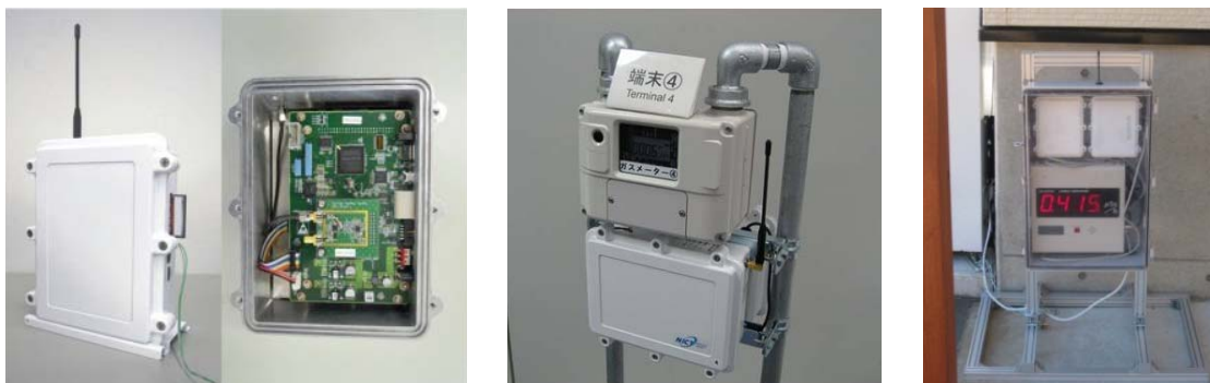
図 1 左: 開発した SUN 無線機、中: ガスメータに取り付けられた無線機、右: 放射線量計に取り付けられた無線機
