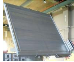
図 1 次世代ドップラーレーダのアンテナ部
