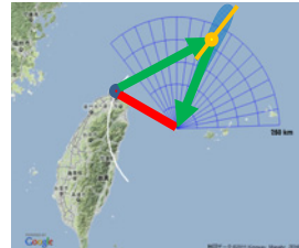
図 2 台湾のレーダ電波を信号元として、与那国を受信点とするバイスタティックレーダによる海面散乱観測実験
