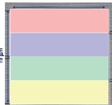
図7 4ピクセル SSPD アレイの走査電子顕微鏡写真と特性均一性
