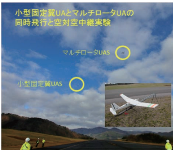
図1 小型無人機による無線中継システムの実証実験(2015年12月、福島スカイパーク)
