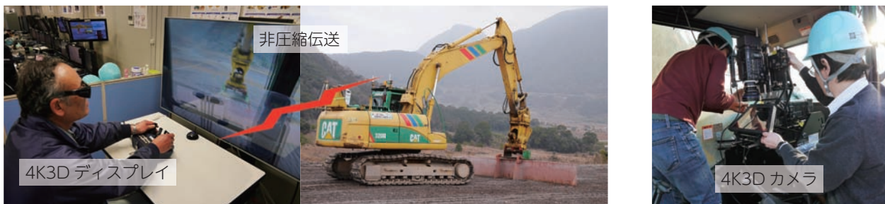
図5 雲仙復興現場において、高精細立体（4K3D）映像の伝送による遠隔作業効率の向上効果を実証
