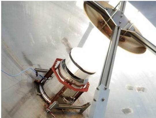
MARBLE 広帯域受信用フィード、 レンズ及び取り付け具などを製作 〔電磁波計測研究所〕 天体からの信号を 6.5-15 GHz の広帯域で 同時受信が可能 (世界初)
