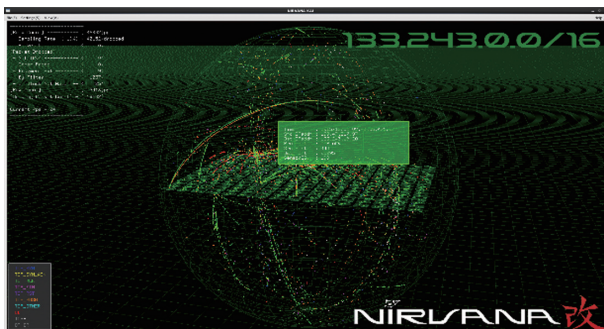
図3 NIRVANA改によるNICT内ネットワークトラフィック監視（DMZに設置したサーバーを監視している）
