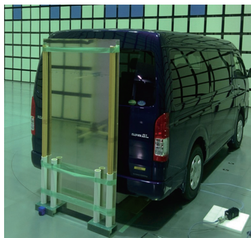
図4 ワイヤレス電力伝送装置に対する実車を用いた接触電流測定
