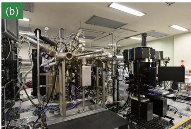
写真1 (a) Class100のエエロールーム、(b) 高品質結晶を製作するための分子線エピタキシー装置
