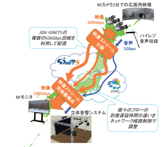
図3 100 G超の8K非圧縮映像及び16チャンネルハイレゾ音声のマルチパス分割伝送
