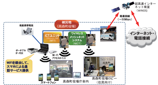
図2 熊本地震時の無線通信による通信環境提供の概要
