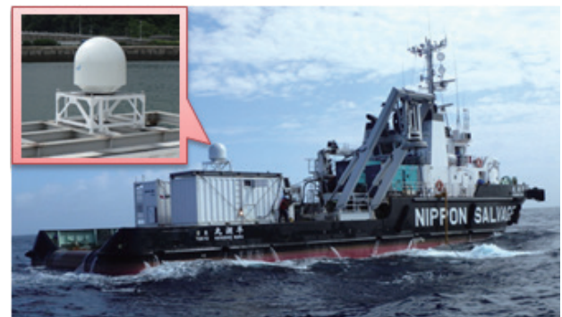
図6 映像伝送実験時の船舶搭載地球局
