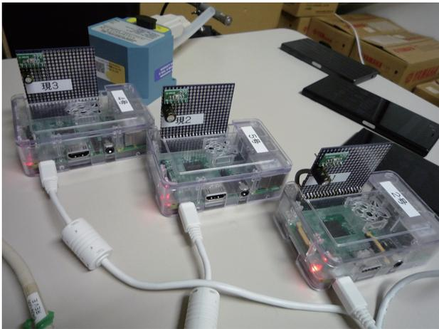
図6 MEMS気圧センサとRaspberry Piで構成される観測装置
