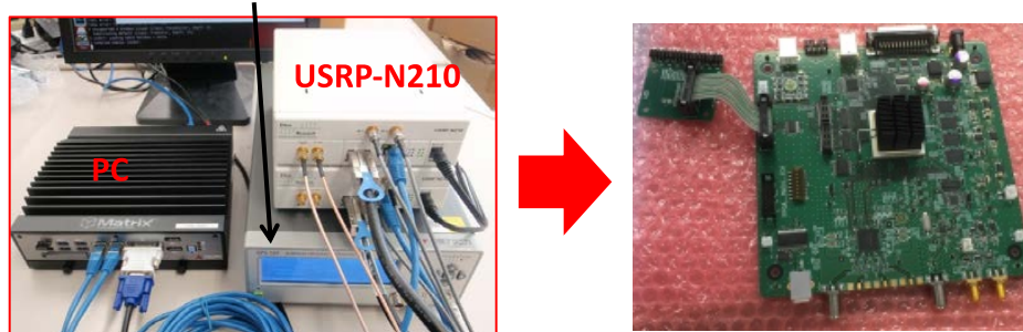
図2 地上デジタル放送波を利用した水蒸気観測システム、プロトタイプ版（左図）と普及版のFPGAボード（右図）
